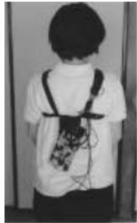
図2 電気角度計を装着したまま日常業務における一般介助, おむつ交換および入浴介助作業における腰椎の屈曲角度を連続的に測定した。一般介助と入浴介助の測定は, 周波数10 Hzで時間は30分間とした。あわせて両側傍脊柱筋の表面筋電図も測定した。
